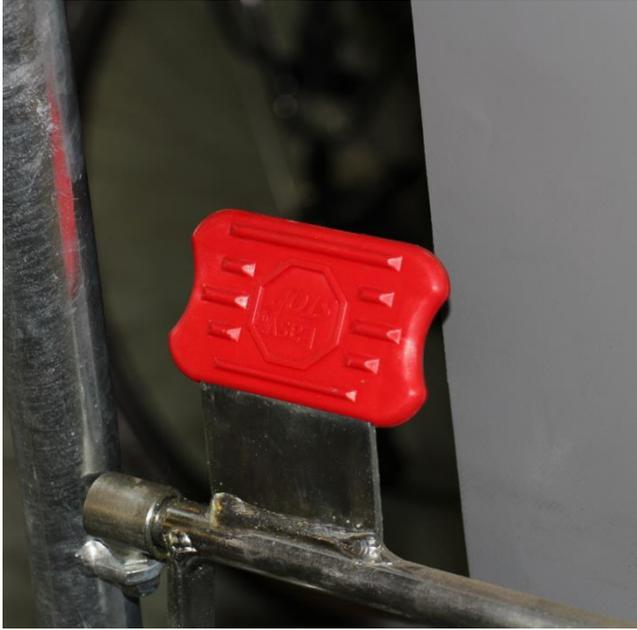
Die Feststellbremse mit dem roten Hebel einlegen, damit die Corlette nicht davon rollt
